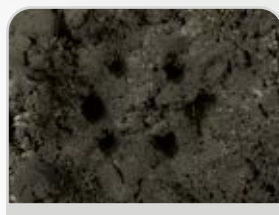
Η μύτη ακροφυσίου μπεκ ψεκασμού GDI με αποθέσεις οπτάνθρακα, μετά από μια φάση δοκιμής λερώματος (Dirty-Up, DU) 48 ωρών.
